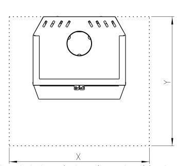
Dimensioni min. per la piastra di protezione del pavimento X/Y = in conformità alle leggi e alle normative nazionali
