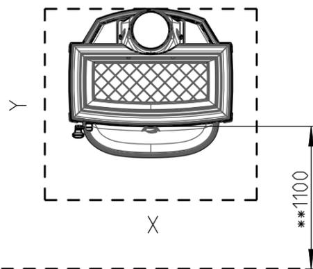
Dimensioni minime per la piastra di protezione del pavimento
