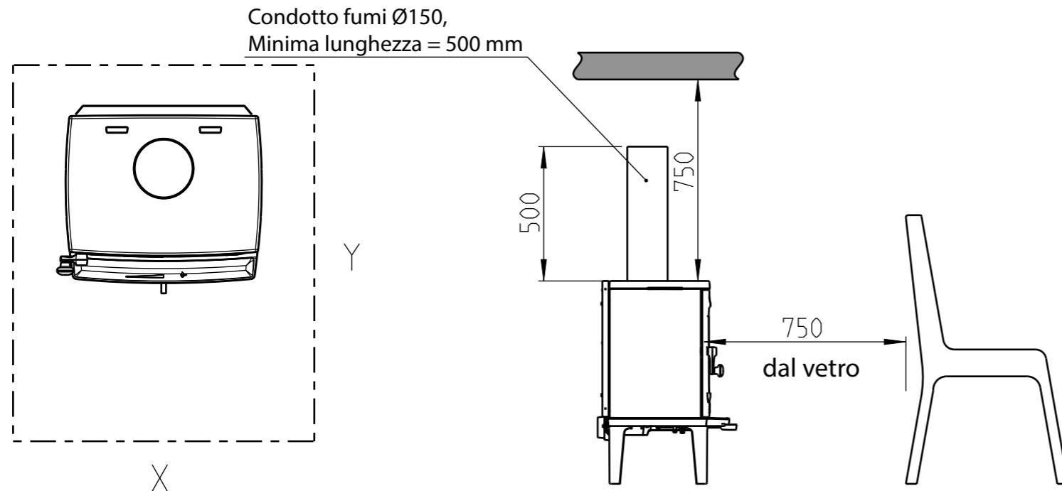
Dimensioni minime per la piastra di protezione del pavimento
