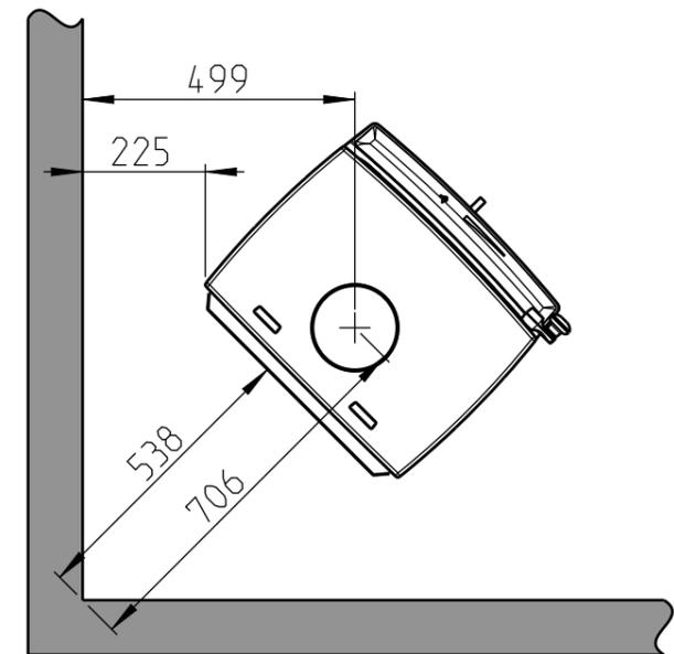
Dimensioni minime per la piastra di protezione del pavimento
