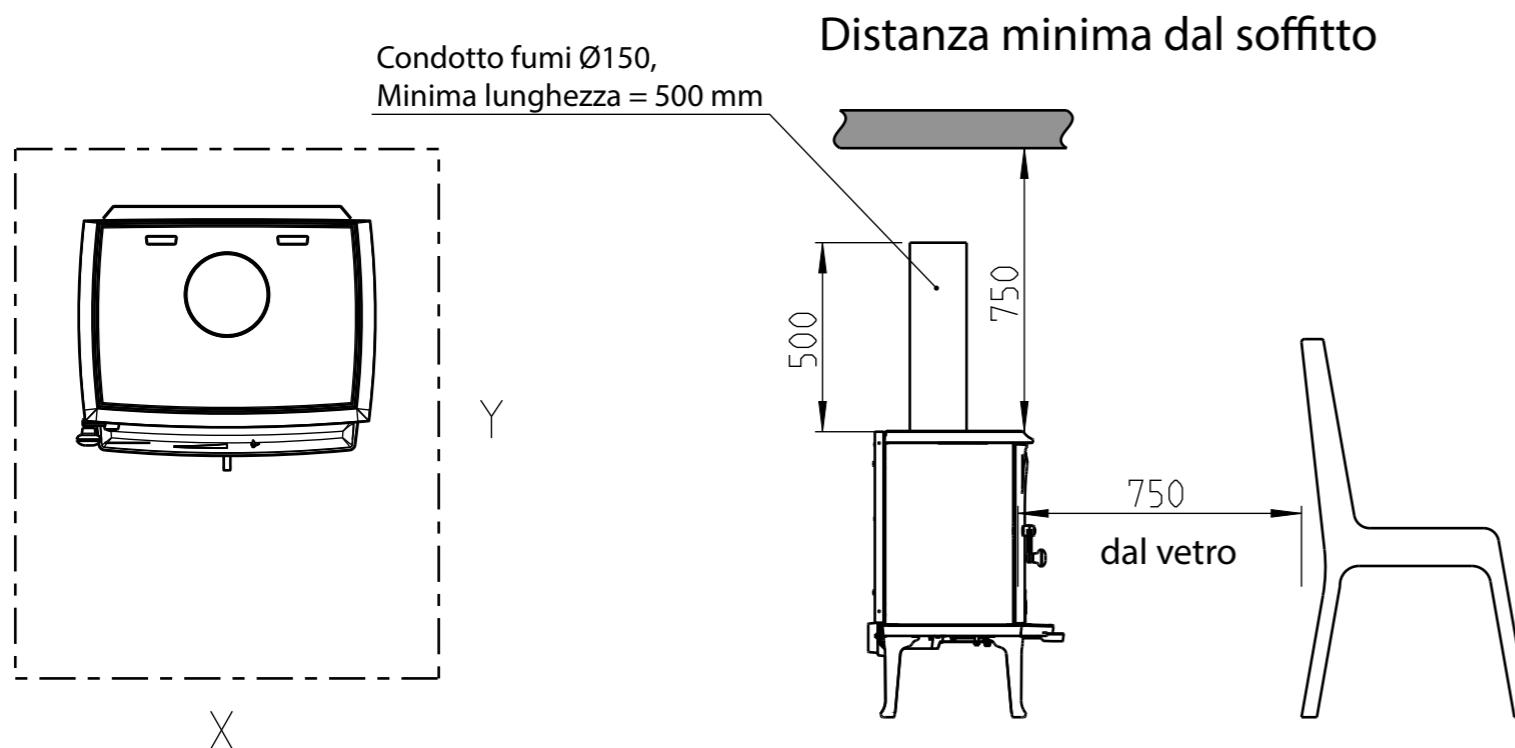
Dimensioni minime per la piastra di protezione del pavimento
