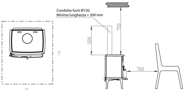
Dimensioni minime per la piastra di protezione del pavimento X/Y = In conformità alle leggi e alle normative nazionali
