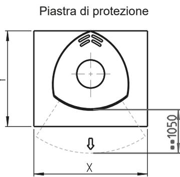
Dimensioni minime per la piastra di protezione del pavimento
