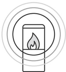
L'irraggiamento è il calore emesso direttamente dall'apparecchio. I raggi si diffondono nell'aria fino a raggiungere un materiale in grado di assorbirli, riscaldandolo. Questo tipo di riscaldamento è consigliato per ambienti con soffitti alti, per case esposte al vento o difficilmente riscaldabili e per grandi volumi.
