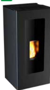
Ecco il modello di potenza 12 kW. Combustione chiusa, la Jøtul PF 1230 S, è dotata di 2 ventilatori di convezione addizionali con distributore d'aria calda fino a 14 metri di percorso lineare. I ventilatori sono escludibili permettendo alla stufa di funzionare a convezione naturale.
